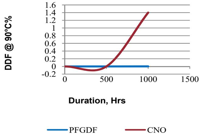
Fig. 8: Dielectric Dissipation Factor
